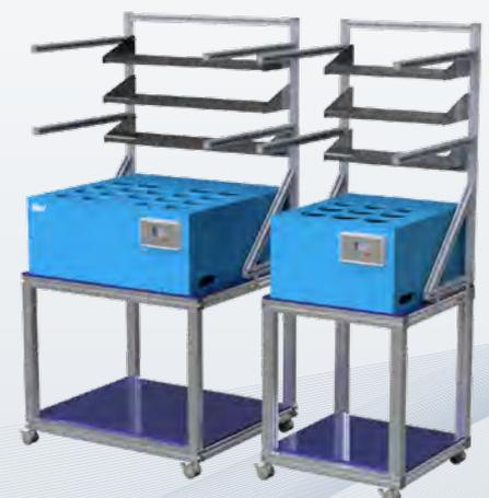
Die Abbildung zeigt die Tische mit den aufstehenden Öfen sowie dem Rack für MilliGascounter und CO<sub>2</sub>-Absorptionsflaschen. Das Rack kann zur einfachen Installation und Handhabung der MilliGascounter und CO<sub>2</sub>-Absorptionsflaschen vor- und rückwärts verschoben werden.
